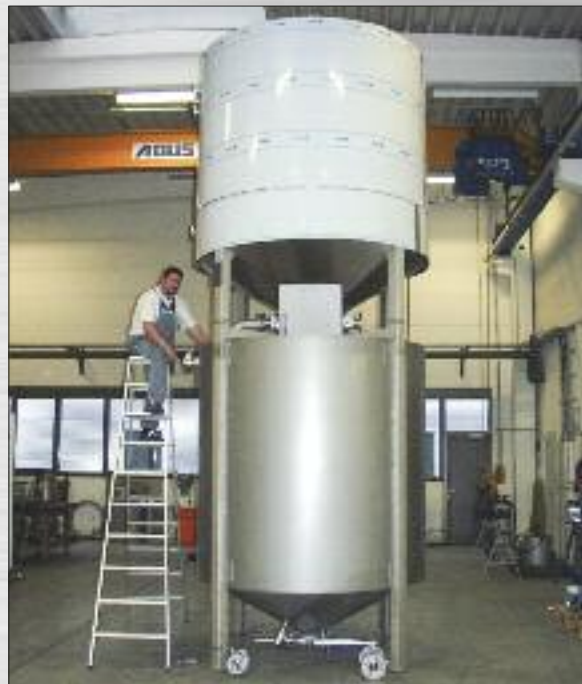
Kunde: MPT Rodgau Projekt: Ansatz-, Dosierstation Fa. Nabaltec, Behälter oben mit dampfbeheizter Halbbrh- schlange, Isolierung und Edelstahlverkleidung, Material 1.4301
