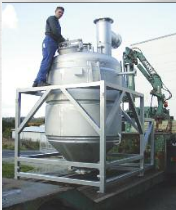
Kunde: Umweltschutz / Recycling Unternehmen Projekt: Doppelwandige, beheizte Behälter zur Lösemittelaufbereitung
