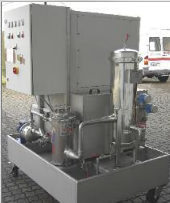
Kunde: WM Consult Projekt: Filter und Rückkühleinheit für Bearbeitungsöle
